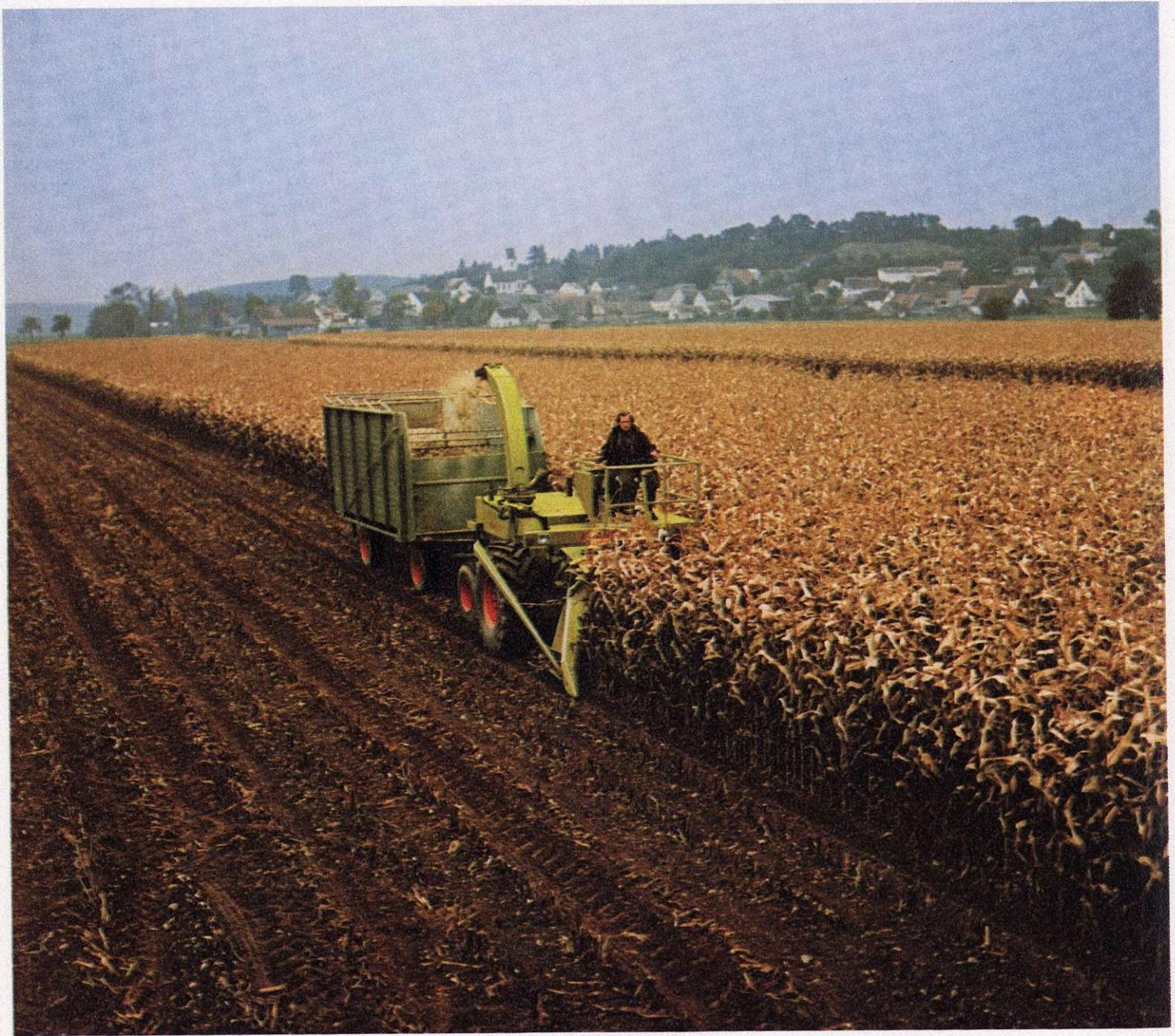
Auch beim Häckseln von Silomais zeigt der JAGUAR 80 SF, was in ihm steckt. Hier beeindruckt seine Leistungsfähigkeit besonders: stündlich werden bis zu 100 t bei 4,6 mm theoretischer Schnittlänge verarbeitet.
